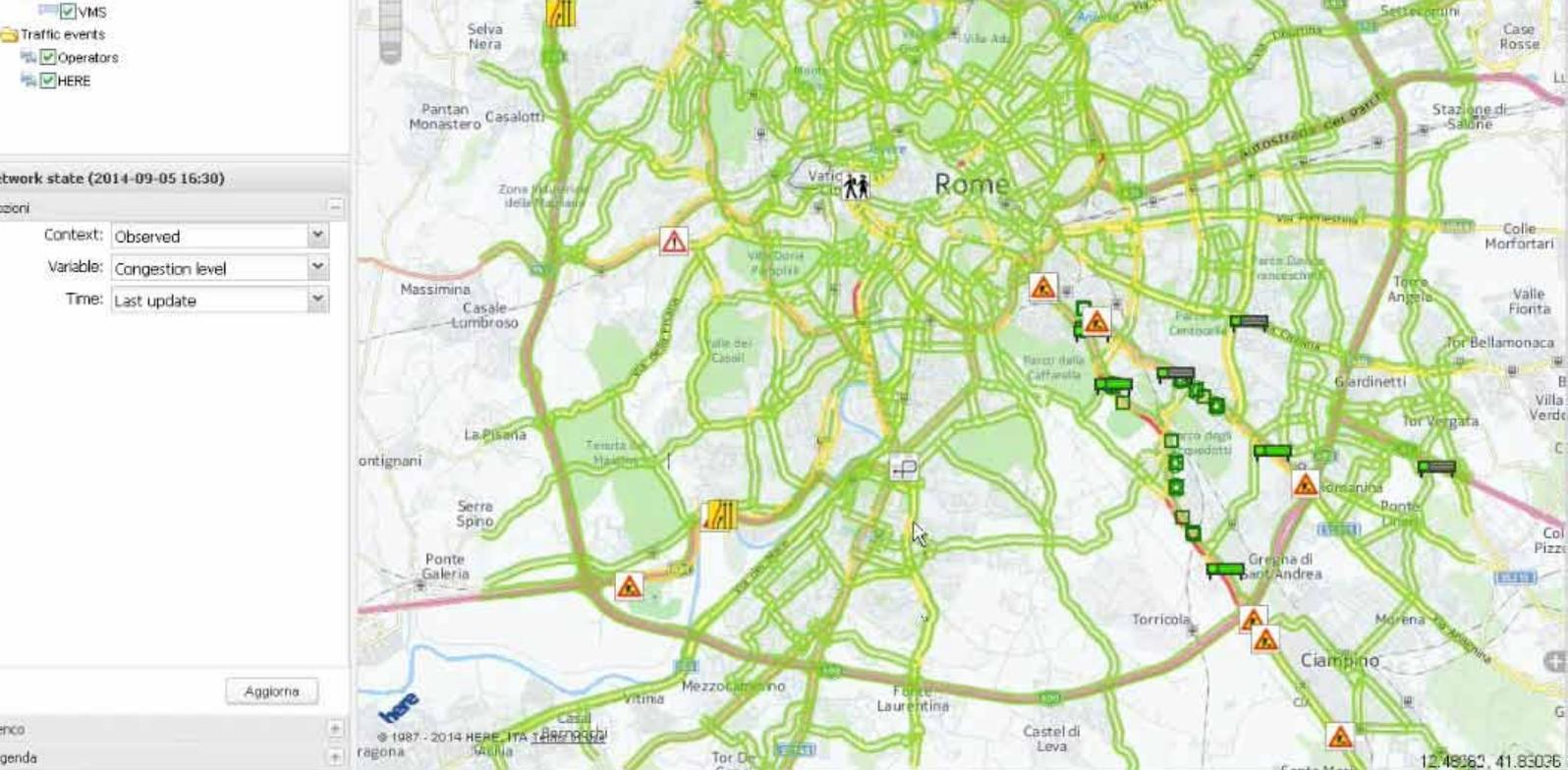
Karten-basiertes Verkehrsmanagement auf Basis von Detektionseinrichtungen und Floating Car Data im Südosten der Ewigen Stadt
