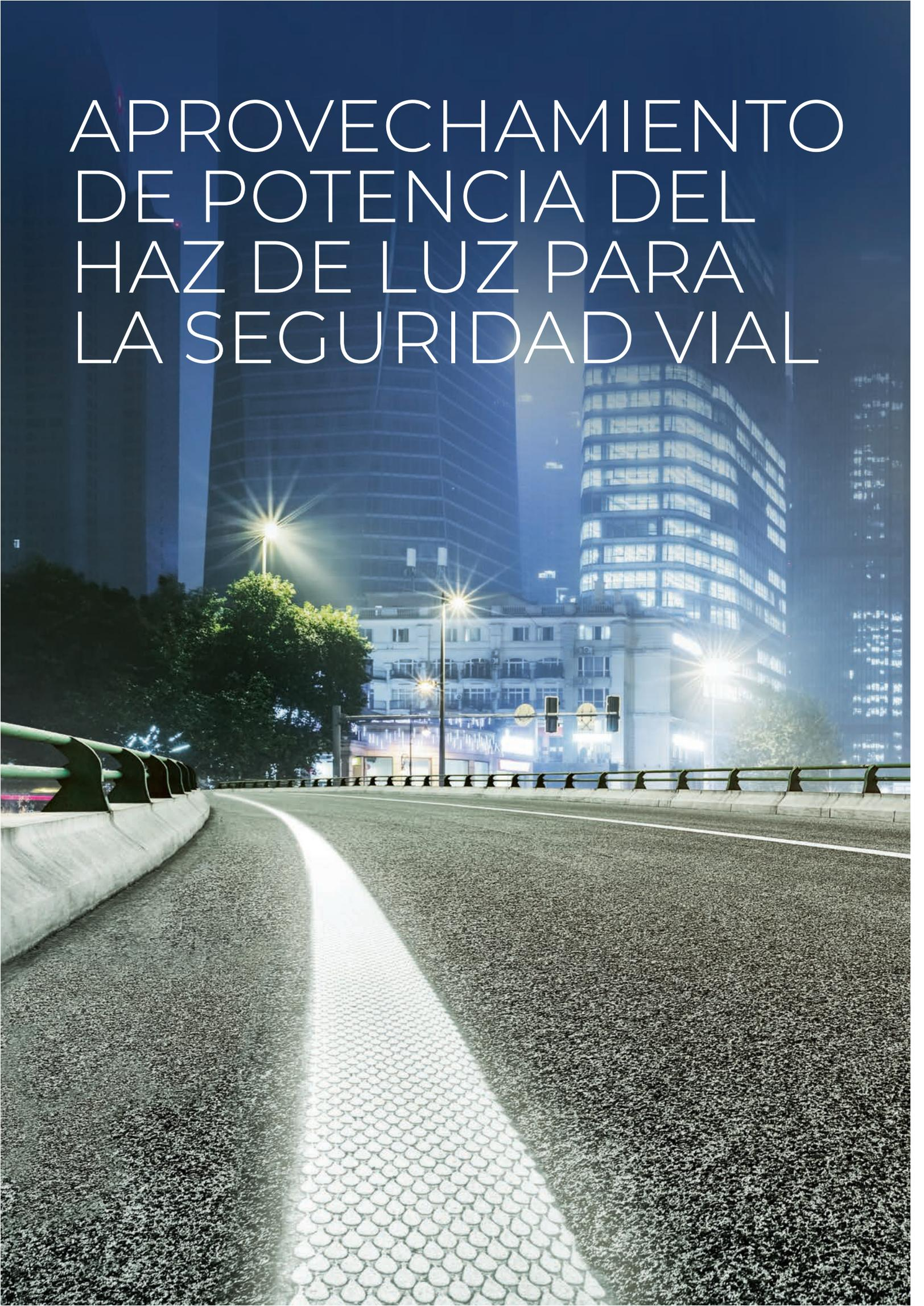
"Las condiciones difíciles de las carreteras son una de las causas más frecuentes de accidentes. Las modernas microesferas de vidrio de alta calidad pueden reducir este riesgo, especialmente por la noche y en condiciones de humedad. Aumentan la visibilidad de las demarcaciones viales de forma significativa, guiando a los usuarios de la carretera a su destino de forma más segura".
