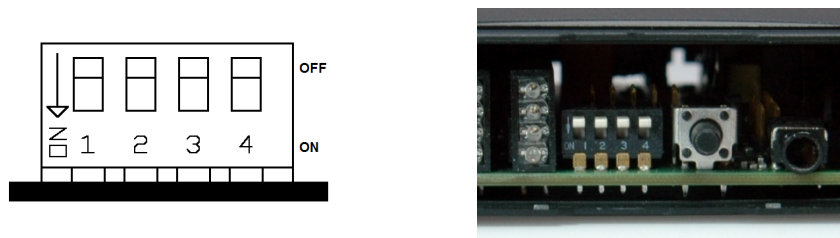
Abbildung 9: Schalter zur Terminierung und Adressierung der RS485-Schnittstelle
