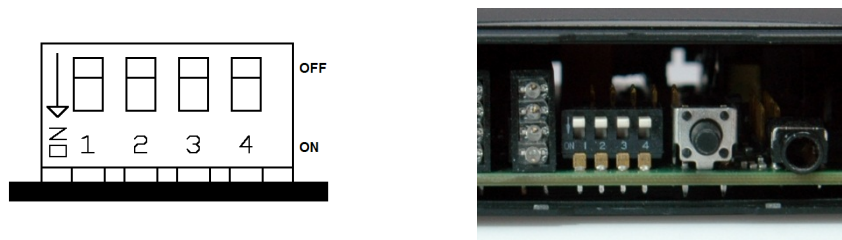
Abbildung 9: Schalter zur Terminierung und Adressierung der RS485-Schnittstelle
