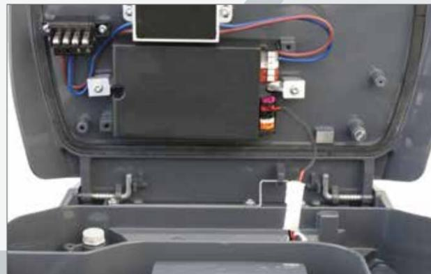
Werkzeugloser Wechsel der Treibereinheit
