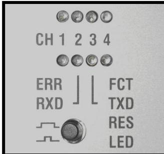
Abbildung 4: LEDs und Taster an der Frontplatte des MC2224
