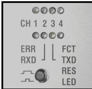
Abbildung 4: LEDs und Taster an der Frontplatte des IG746
