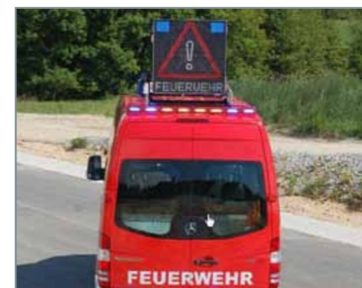
Mobiles LED-Wechselverkehrszeichen am Dach montiert, vollflächig, vollfarbig RGB, batteriebetrieben, gesteuert über PDA
