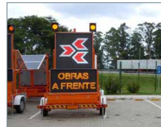
Mobiles LED-Wechselverkehrszeichen auf Anhänger montiert, vollflächig, obere Anzeigefläche vollfarbig, untere Anzeigefläche einfarbig gelb, mit Solarzellen betrieben
