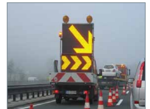
Mobiles LED-Wechselverkehrszeichen auf LKW montiert, vollflächig, obere Anzeigefläche zweifarbig rot/gelb, untere Anzeigefläche einfarbig gelb, batteriebetrieben, gesteuert über PDA
