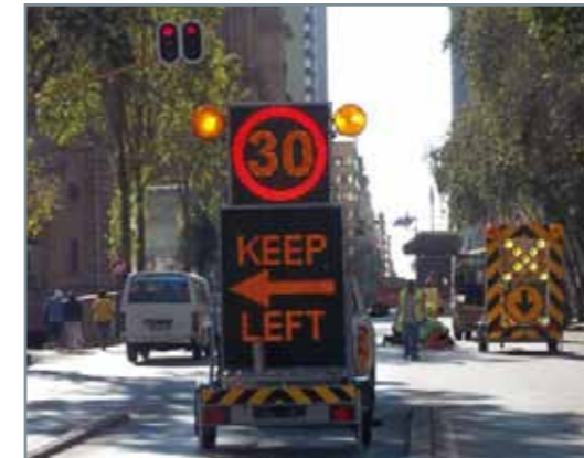
Mobiles LED-Wechselverkehrszeichen auf Anhänger montiert, vollflächig, obere Anzeigefläche zweifarbig rot/gelb, untere Anzeigefläche einfarbig gelb, betrieben mit Diesel-Generator, gesteuert über PDA
