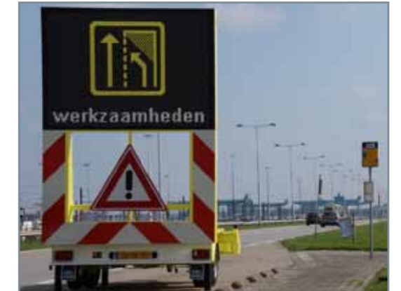
Mobiles ECO LED-Wechselverkehrszeichen auf Anhänger montiert, vollflächig, vollfarbig RGB, mit Solarzellen betrieben, GPRS/GPS Kommunikation
