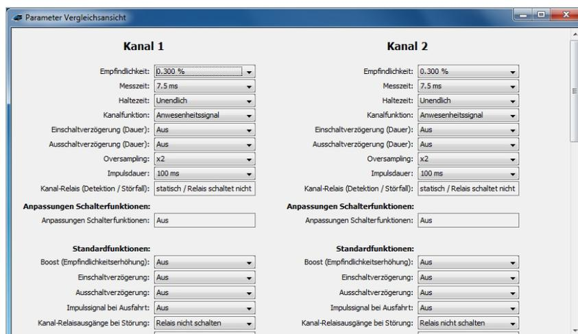
Die Software bietet eine optimale Unterstützung bei der Analyse und Fehlersuche. Klartextinformation und Diagnosewerte werden für den angeschlossenen Detektor und die einzelnen Detektorkanäle dargestellt. Die praktische Vergleichsansicht für beliebige Kanäle gibt einen zusätzlichen Überblick zu den Kanal- und Parameterunterschieden. Zur Dokumentation beinhaltet das Programm eine grafisch aufbereitete Druckfunktion aller Detektorparameter.
