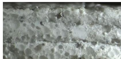
Werden Fahrbahnmarkierungen fachgerecht instandgehalten, stapeln sich Schichten von Markierungsmaterial und Reflexglasperlen übereinander, bis die Markierungen staubfrei abgetragen werden und das Material fachgerecht entsorgt wird.
