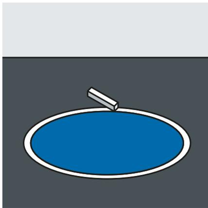
La zone à marquer doit être propre, totalement sèche et exempte de poussière et de graisse. Dessiner les contours du dessin / du marquage à la craie.
