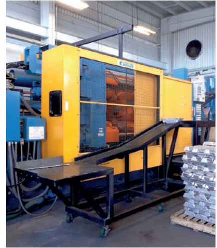
1100 ton casting machine
