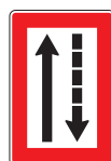
B. 3b Gebot die Fahrwasserseite zu halten, die auf der Steuerbordseite des Fahrzeugs liegt.
