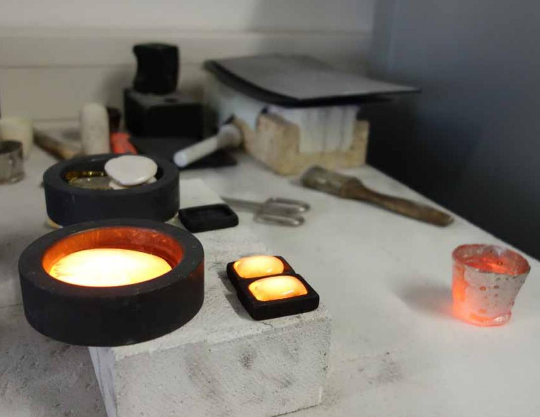
Probekörpererstellung zur Brechungsindex-Ermittlung bei Hochindex-Perlen
